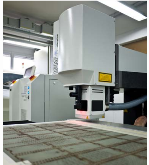
Diodengepumpter UV-YAG Laser mit einer Leistung von 10W
